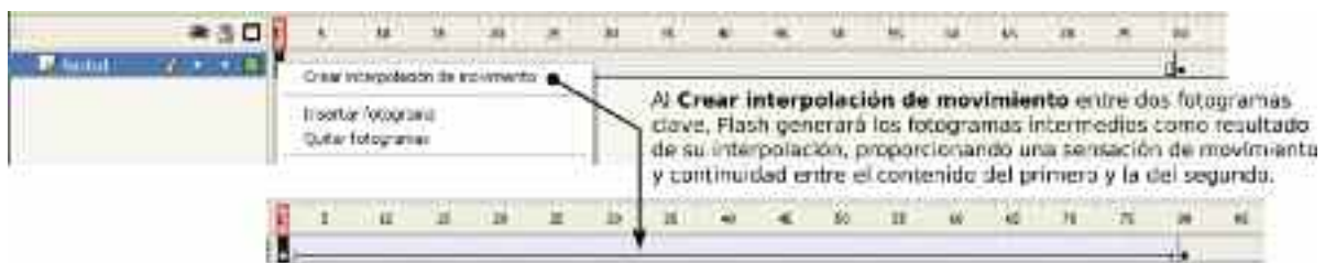
Figura 4.15. La interpolación de movimiento entre dos fotogramas clave es utilizada para proporcionar sensación de movimiento en las animaciones Flash
