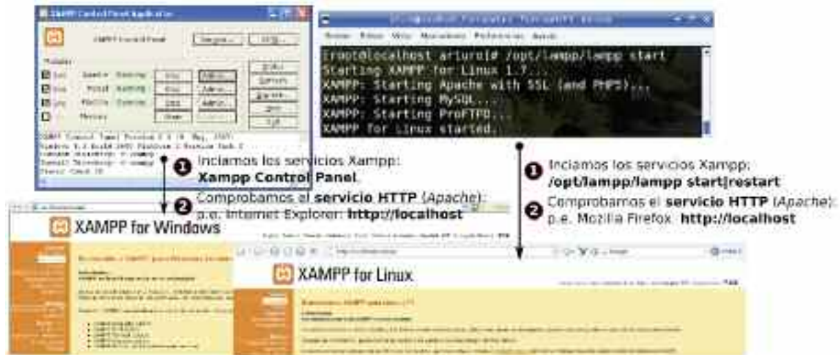
Figura 6.5. Tras arrancar el multiservicio Xampp podemos comprobar el correcto funcionamiento de Apache desde un cliente Web, “ http://localhost ”
