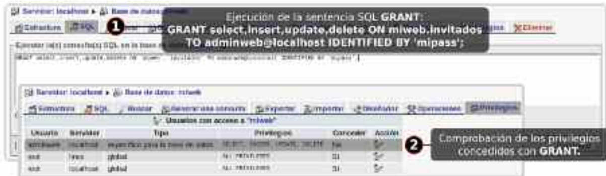
Figura 8.11. Creación del usuario adminweb y concesión de privilegios mediante la sentencia SQL GRANT
