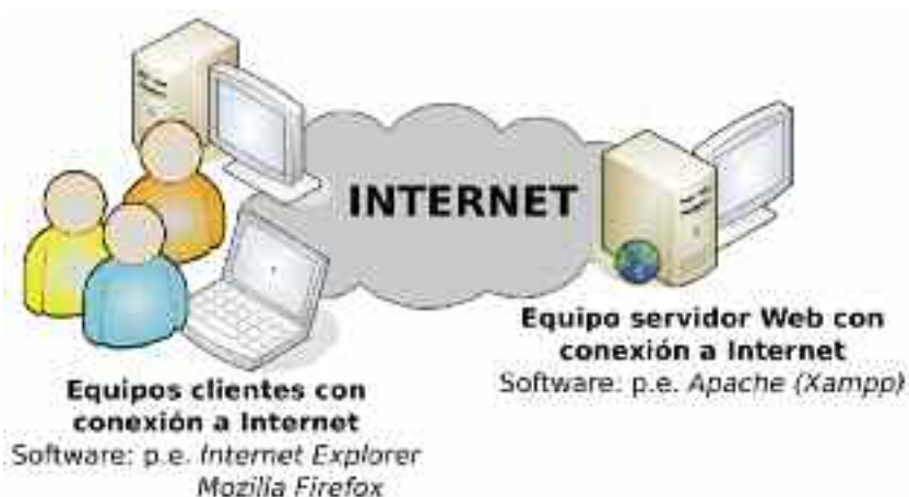
Figura 12.1. Esquema simplificado de conexión entre clientes y servidor en Internet
