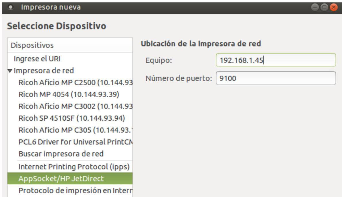
Automáticamente nos buscará el controlador adecuado para el equipo (el paquete que instalamos anteriormente), y nos saldrá el cuadro de accesorios de la máquina por si tenemos alguno suplementario instalado y tenemos que indicárselo.
