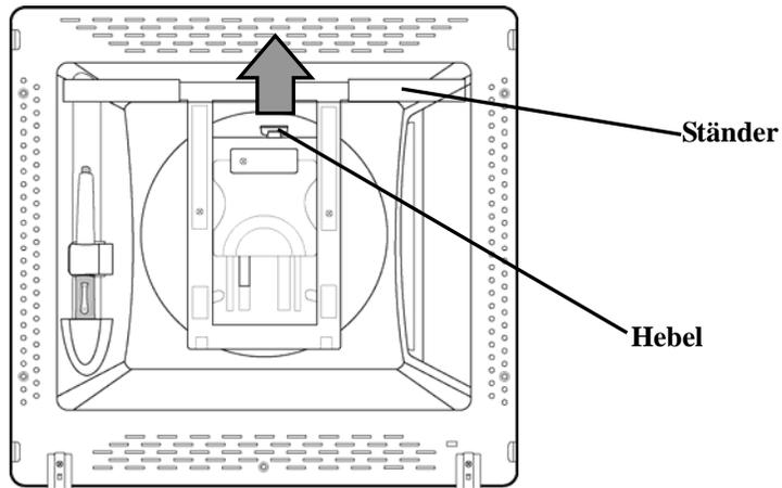
(2) Bringen Sie den Ständer in die gewünschte Position und entfernen Sie den Hebel
