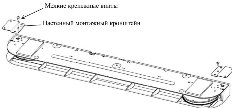
(2) Совместите центр дигитайзера с центром проекционной зоны, разместите его на 5 см (2 дюйма) выше проекционной зоны и установите его таким образом, чтобы он расположился параллельно границе проекционной зоны.
